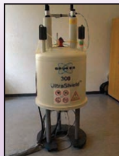
شکل ۲: یک دستگاه بیناب‌نما در تشدید مغناطیسی هسته
