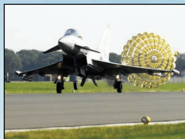
شکل (۱۱). استفاده از نیروی پسا در هواپیماها به عنوان ترمز
