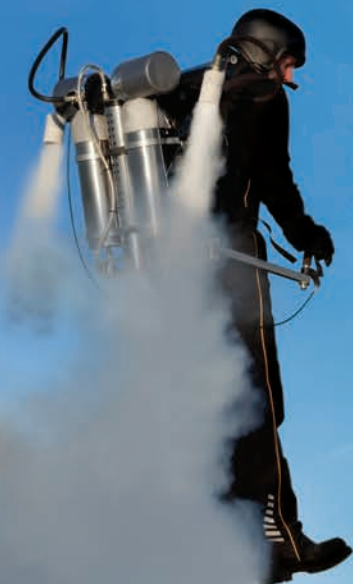
► شکل (۴). کوله پرنده، مجهز به موتور راکتی
