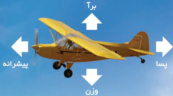
شکل (۹). چهار نیروی اصلی وارد بر یک هواپیما
