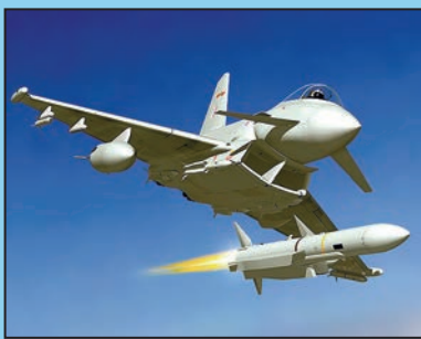
شکل ۸. موشک هوا به هوا میتیور مجهز به پیشرانده رم-راکت
