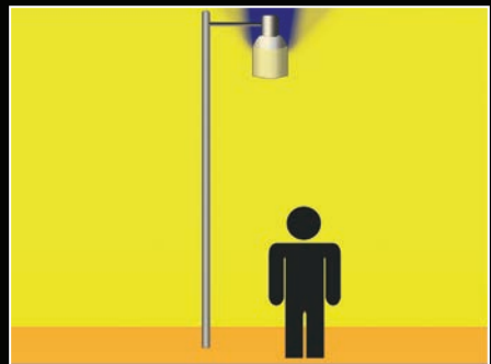
▲ دو نمونه از لامپ‌های با طراحی نامناسب؛ بیشتر نور به سمت آسمان می‌رود.
