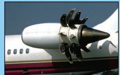
▲ شکل ۱۱. گردش متقابل فن‌های ملخی در یک موتور پراپ فن
