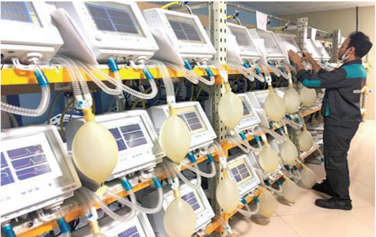
تولید ونتیلاتور در شرکت دانش‌بنیان احیاء درمان پیشرفته، تولیدکننده عمده ونتیلاتور، مستقر در پارک علم و فناوری خراسان
